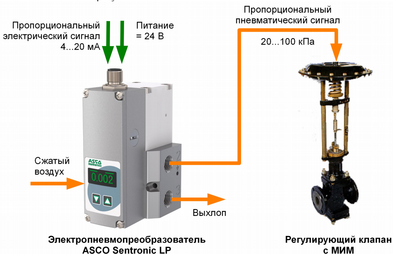
Рисунок 1 – Схема соединения ЭПП ASCO Sentronic LP и регулирующего клапана с МИМ
